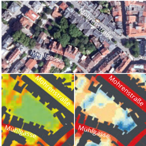
Abb. 21: Innenhof zw. Mohrenstraße und Mühlgasse (Luftbild, gefühlte Temperatur am Tag (links) und Temperatur in der Nacht (rechts)) [2]
